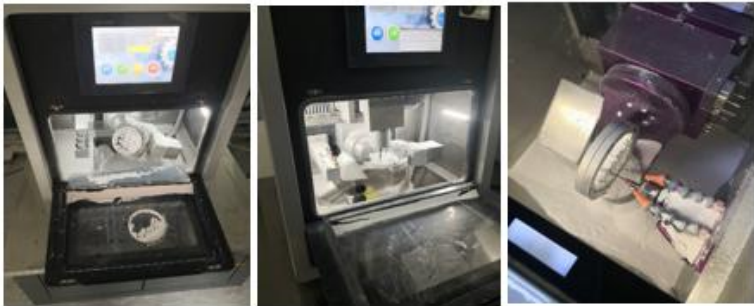
▲ 切削设备在对氧化锆材料进行切削
